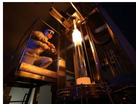
Процесс вытяжки оптического волокна. Из одной преформы получается более 1000 км оптического волокна.
